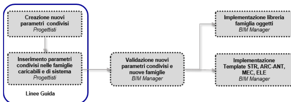
Fig. 30 – Flusso aggiunta nuovi parametri condivisi
